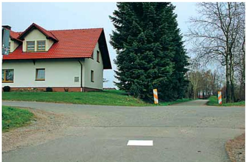
Abb. 3: signalisierter Passpunkt
